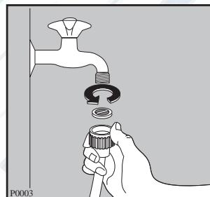
**Важно:** Не забудьте воспользоваться переходником при подключении шланга к крану с резьбой 3/4"-1/2" (при необходимости). Удлинять наливной шланг запрещается. Если он слишком короткий, то надо просто заменить его на более длинный шланг, рассчитанный на высокое давление воды.
